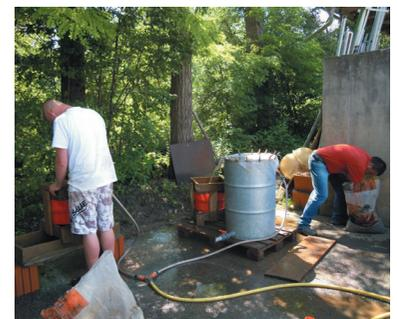
Flotation von Sedimentmaterial
